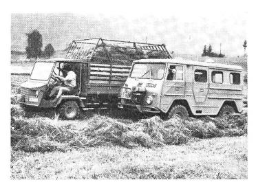
Abb. 4: Drehmomentmessungen an einem Universal-Transporter während des Ladevorganges.
