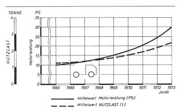
Abb. 10: Die steigende Tendenz der Motorleistung und der Nutzlast ist aus diesem Diagramm zu ersehen.
