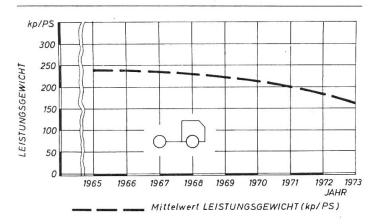
Abb. 11: Das Leistungsgewicht wird immer günstiger und damit die Arbeitsleistungen angehoben.
