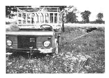
Abb. 5: Ein Motorkarren mit Seitenmähwerk und hydraulischem Mähantrieb.
