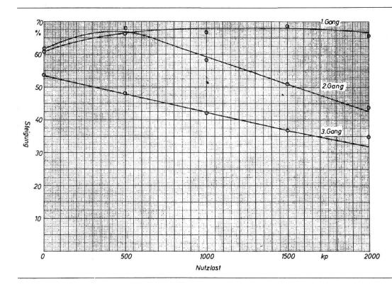
Abb. 6: Steigleistungsdiagramm eines Transporters.
