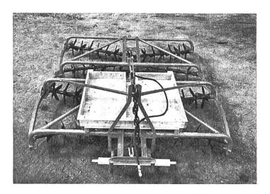
kann z. B. zur Stoppelbearbeitung mit der Hälfte des Eggengewichts belastet werden; höhere Zusatzgewichte werden auf die Seiten verteilt.
