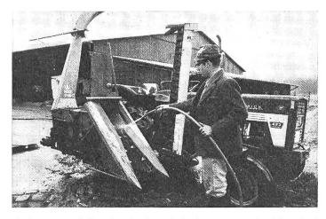
Sofort gereinigt ist halbe Arbeit — so wie hier bei dem Maishäcksler, der nach dem Einsatz sofort mit einem Wasserstrahl abgespritzt, nachgesehen und eingeölt wird. So kann die Erntemaschine die ruhigen Monate überdauern, ohne Rost anzusetzen.
