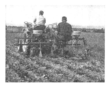
Eine für das Ausbringen der Granulate speziell konstruierte Maschine. Sie ist handlich, kann leicht auf jedes Vielfachgerät montiert werden und erlaubt eine einwandfreie Streuarbeit bei flüssigem Arbeitstempo. Sie eignet sich auch gut für den gemeinschaftlichen Gebrauch.
