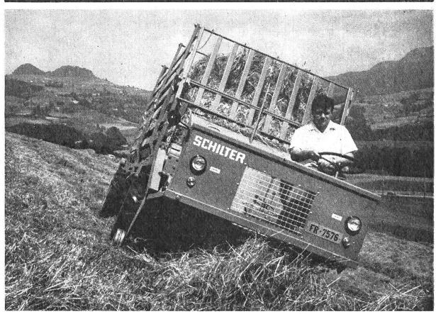
Ein Mehrzweckfahrzeug, wie man es braucht im modernen Betrieb. Mit der Futteraufnahme vor den Vorderrädern: zum Eingrasen, Silieren, Heuen, Emden. Mit dem separaten Kratzboden zum Mistzetten. Mit Pump- oder Vakuum-Druck-Fass. Geeignet für alle Arbeiten mit der Seilwinde. Und für alle Transporte bis 2,5 Tonnen Nutzlast. Wirklich tiptop, auch sein starker 40-PS-Perkins-Dieselmotor. Der Ladetraktor für Sie!
