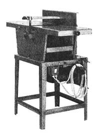
3 PS, 380 V, 5 m Kabel, 2-tourig: 3500 und 6500 Touren. Hobelmaschine kombiniert mit Fräse mit 30 cm-Blatt.
