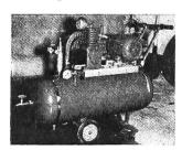
fahrbar, vollautomatisch, 12 m³/h, 50 l-Kessel, Druckreduzierventil, 3 Anschlüsse
