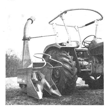
Der neuartige Schneckenzubringer sichert zuverlässigen Einzug. Das Schneidwerk arbeitet nach dem Rotationsprinzip. Zwei rotierende Messer mit gegenläufigen Schneiden gewährleisten einen sauberen Mähvorgang.
