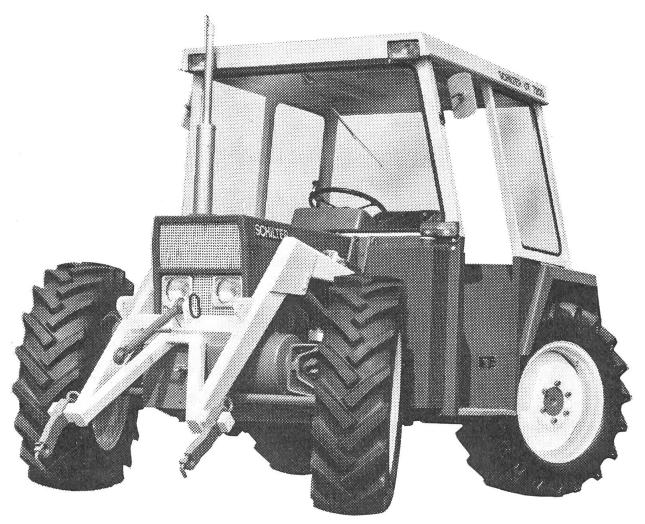
Dreipunkthydraulik und genormte Zapfwellen hinten und vorn. Gleichzeitiger Antrieb von Heck- und Frontgeräten. Drei Typen:
