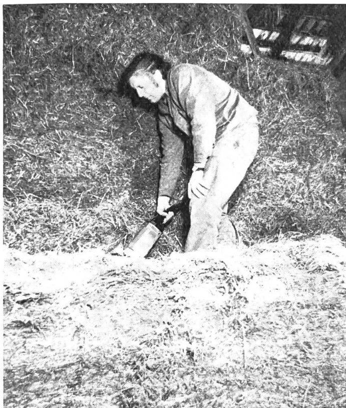
Abb. 3: Die Heuschrote ZIP im Einsatz. Das Schroten erfordert keine grosse körperliche Anstrengung.
