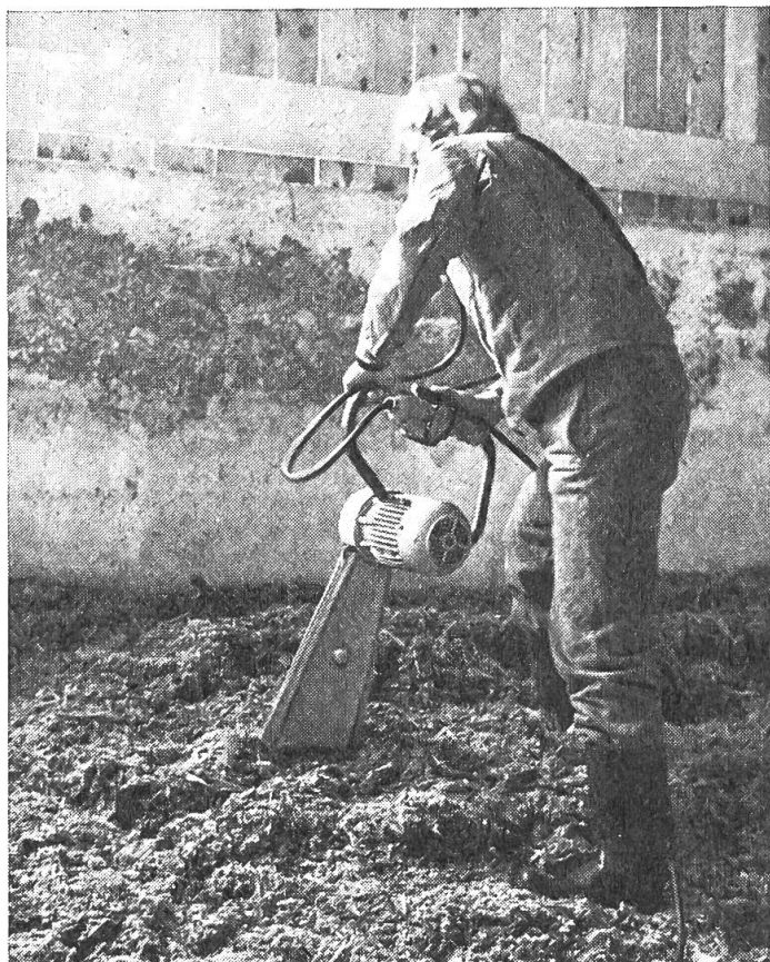
Abb. 4: Die Silageschrote SCHNEIDFIX im Einsatz. Schneidprinzip: Doppelmessermähbalken. Das Kabel wird am besten über die Schulter gelegt. Preis dieses Modells: Fr. 1640.—.
