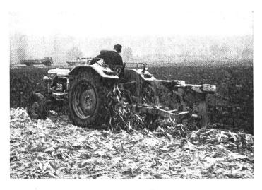
Abb. 11: Unterpflügen von zerkleinertem Maisstroh.
