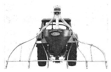
Abb. 5: Für den Schleuderstreuer «Diadem» ist neuerdings eine Reihen-Streuvorrichtung erhältlich.
