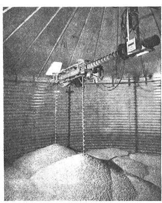
Abb. 7: Der Silo-Korntrockner «Privé» ist mit einem Schneckenrührwerk ausgerüstet, mit dem der ganze Siloinhalt gründlich durchgerührt wird.
