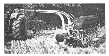
Abb. 3: Geräteträger «Huard» ermöglicht die Durchführung der Minimalbodenbearbeitung mit vorhandenen Geräten.
