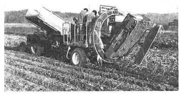
Abb. 8: Bei den Kartoffelvollerntern setzt sich die Ausführung mit dem Rollboden-Bunker konsequent durch.
