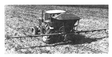
Abb. 4: Pneumatischer Düngerstreuer «Nodet» kann bei der Verwendung einer Spezial-Dosierwalze zum Ausbringen von Mikrogranulaten eingesetzt werden.
