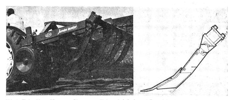
Abb. 1: Tiefgrubber «Vicon» – Die starren Zinken sind flach gestellt und benötigen dadurch weniger Zugkraft.
