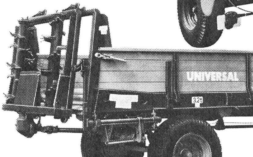
Der tausendfach bewährte Kemper-Frässtreuer mit der feinen Fräsanarbeit für Wiesendüngung. Streubreite einstellbar von 2,5 bis 8 m.
