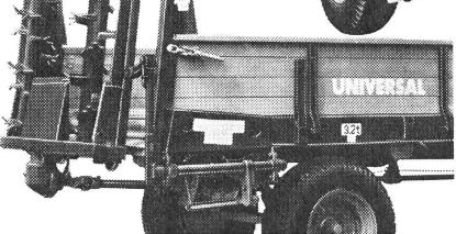
Der tausendfach bewährte Kemper-Frässtreuer mit der feinen Fräsarbeit für Wiesendüngung. Streubreite einstellbar von 2,5 bis 8 m.
