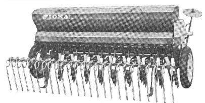
leicht und stabil, verschleissfest und wartungsfrei durch das unverwüstliche Säsystem aus NYLON! Genaue Aussaat — Vollautomat. Spuranzeigerwechsel. Schare mit einstellbarem Federdruck. Fragen Sie uns nach den günstigen FIONA-Preisen!
