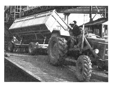
Abb. 1: Mit selbstkippenden Wagen können bei Direktanlieferung unter Umständen lange Wartezeiten vermieden werden.
