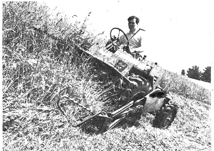
Abb. 9: Eine neue hangspezifische Arbeitsmaschine, die mit dem Mähwerk und einem Heuer ausgestattet werden kann.
