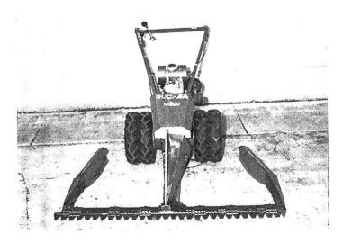
Abb. 7: Die Weiterentwicklung des vor zwei Jahren vorgestellten Motormähers mit fingerlosem Universalbalken.
