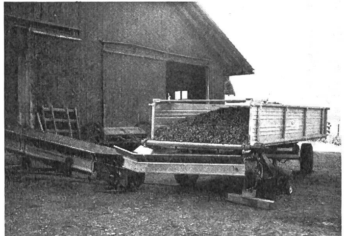
Abb. 9: Kastenwagen mit Abladeteppich ermöglichen ein schonungsvolles Entladen der Kartoffeln.
