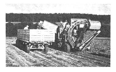
Abb. 7: Kartoffelvollernter mit Rollbodenbunker beim Beschicken von Paloxen während des Arbeitseinsatzes. (Foto FAT)
