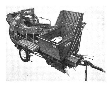
Abb. 5: Fallschutzeinrichtungen vermindern Aufschlagschäden (Werkbild).
