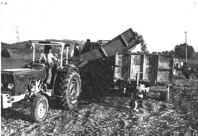
Abb. 6: Kartoffelvollernter mit Rollbodenbunker. (Foto FAT)
