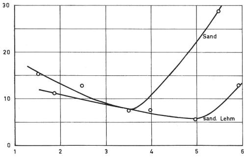
Abb. 4: Einfluss der Bodenart und Fahrgeschwindigkeit auf den Anteil beschädigter Knollen (nach Specht).
