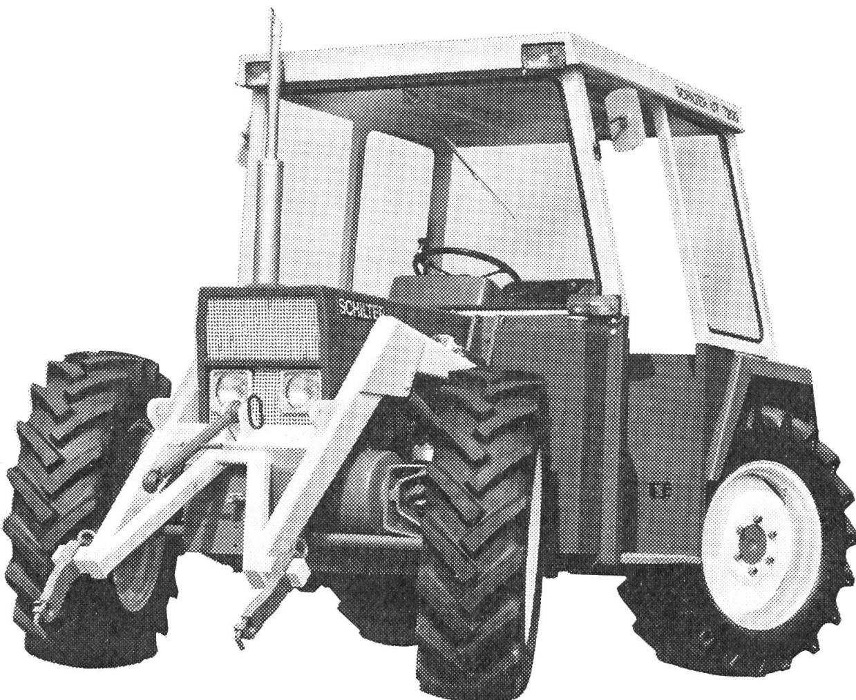
Dreipunkthydraulik und genormte Zapfwellen hinten und vorn. Gleichzeitiger Antrieb von Heck- und Frontgeräten.
