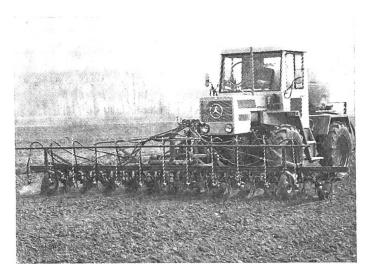
Mit dieser Fronthacke werden 12 Reihen im Abstand von 45 cm bearbeitet. Für die Unterblatt-Spritzung ist zusätzlich eine Spritzanlage vorhanden.
