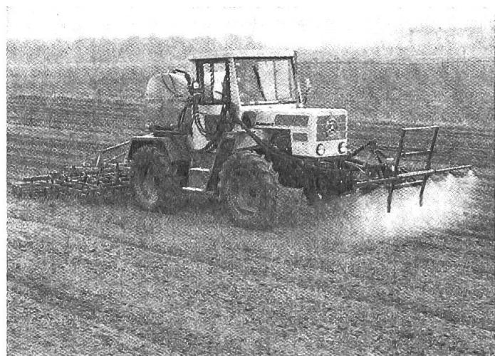
Diese Saatbettkombination, welche für die Straßenfahrt hydraulisch zusammengeklappt wird, arbeitet auf 3,3 m. Der vordere Spritzbalken ist auf die Arbeitsbreite der Kombination abgestimmt.
