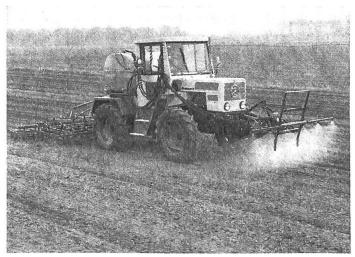
Diese Saatbettkombination, welche für die Strassenfahrt hydraulisch zusammengeklappt wird, arbeitet auf 3,3 m. Der vordere Spritzbalken ist auf die Arbeitsbreite der Kombination abgestimmt.
