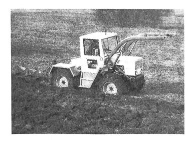
Der echte Allradantrieb mit vier gleich grossen Rädern, die Differentialsperre in beiden Achsen und die optimale Gewichtsverteilung ermöglichen die volle Kraftübertragung auf den Boden.
