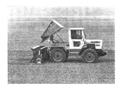
Diese Sämaschine ist für Breiten bis 3 m bestimmt. In Kombination mit dem 1500 l Kipptank können 5-10 ha in einem Zug gesät werden.
