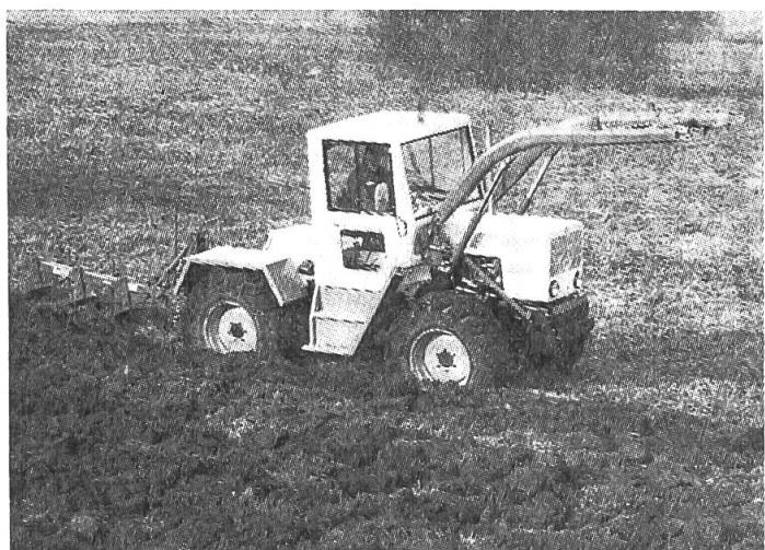
Der echte Allradantrieb mit vier gleich grossen Rädern, die Differentialsperre in beiden Achsen und die optimale Gewichtsverteilung ermöglichen die volle Kraftübertragung auf den Boden.
