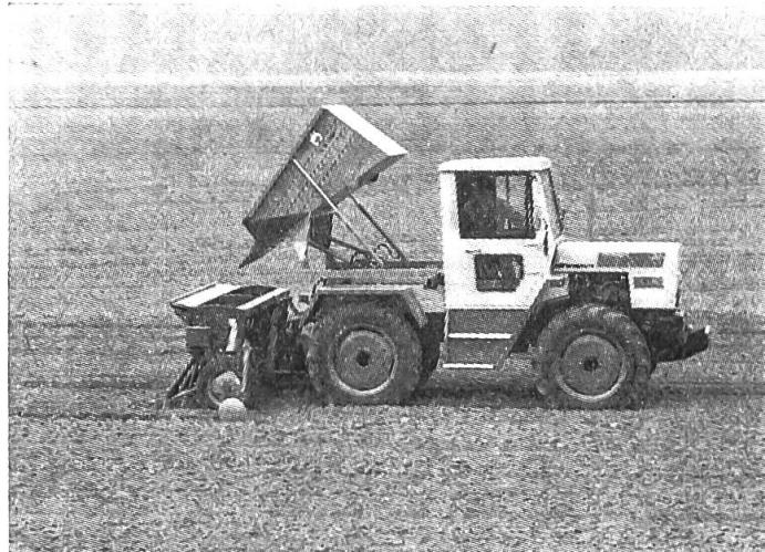
Diese Sämaschine ist für Breiten bis 3 m bestimmt. In Kombination mit dem 1500 l KippTank können 5–10 ha in einem Zug gesät werden.
