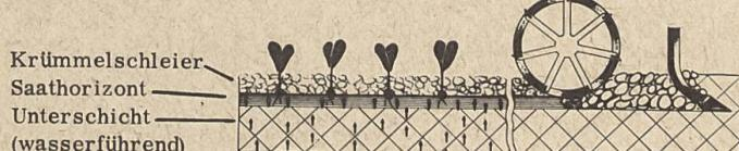
Die RAU-KOMBINATION mit SW-Stegwalzenkrümller bereitet stets einen idealen Saathorizont, mit wasserführender Unterschicht und einem obenaufliegendem Krümmelschleier.
