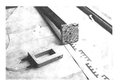
Abb. 3d: Metallsuchgerät (Oszilov) mit Aluminium-Niveauanzeiger
