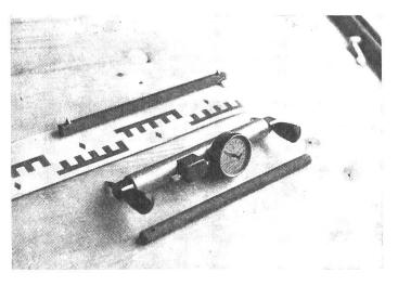
Abb. 3b: mechanischer Dehnweggeber (Deformeter)
