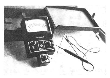
Abb. 3c: Präzisionstastthermometer
