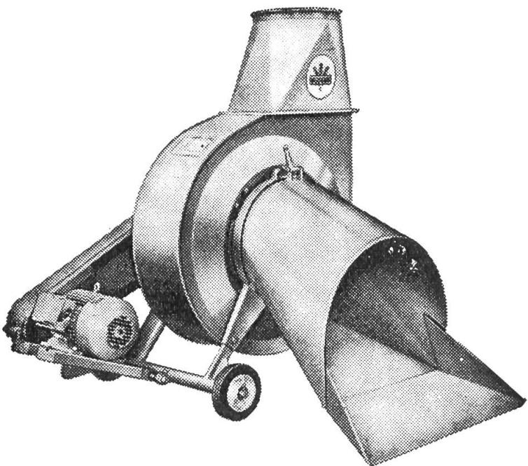
Die Abbildung zeigt Ihnen Typ AG 3/380 mit angebautem Motor, 4-armiger Schneidvorrichtung und Saugkanal mit Leitblech für eine leistungsfähige Rauhfutterannahme. Schneidgebläse Neuero werden nach Ausbau der Schneidvorrichtung (was nur ganz kurze Zeit beansprucht) zu Abladegebläsen. Abladegebläse können auch nur als solche bezogen werden zu einem wesentlich günstigeren Preis. Die Schneidvorrichtung ist auf Wunsch jederzeit nachlieferbar. Lieferung sofort ab Lager Bättwil.
