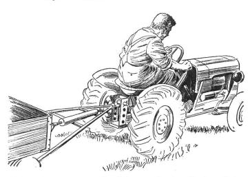
Abb. 7: Tetrax-Bremsbetätigung (hydraulisches Prinzip). Nachdem alle Traktoren nunmehr eine Hydraulikanlage aufweisen, erscheint es naheliegend, diese auch zur Bremsung auszunützen.
