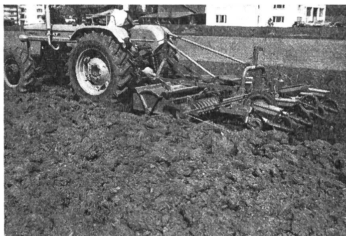
Abb. 5: Gerätekombination mit Fräse, Krumenpacker und Einzelkornsägerät. Diese Art von Kombinationen erfordern grosse Zapfwellenleistungen und vor allem kräftige Hydraulikanlagen.
