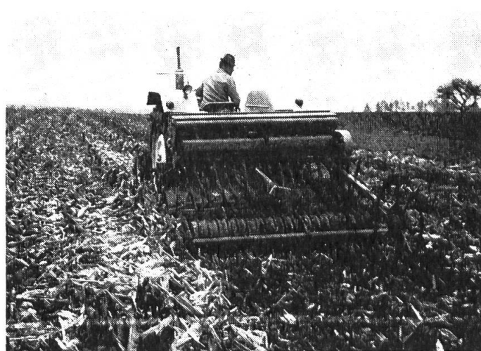
Abb. 8: Frässaat mit Saatgutablage nach der Fräswelle auf abgeerntetem Körnermaissfeld. Für 2,5 m Arbeitsbreite sind bis zu 100 PS erforderlich.
