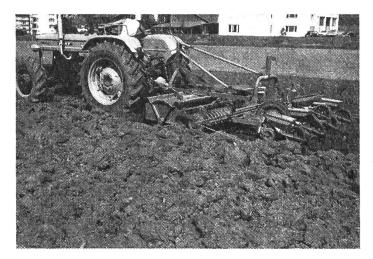
Abb. 5: Gerätekombination mit Fräse, Krumenpacker und Einzelkornsägerät. Diese Art von Kombinationen erfordern grosse Zapfwellenleistungen und vor allem kräftige Hydraulikanlagen.
