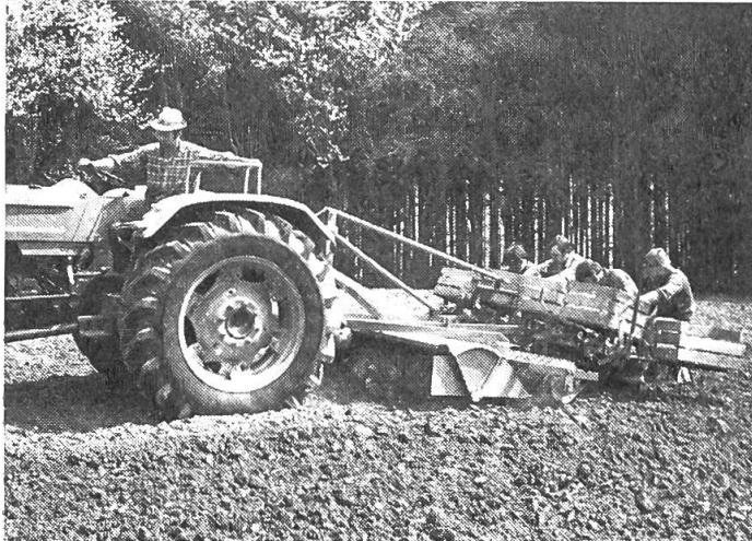
Abb. 9: Kombination Saatbettbereitung (Fräse) und Pflanzen (Kartoffelsetzgerät) in einem Arbeitsgang.
