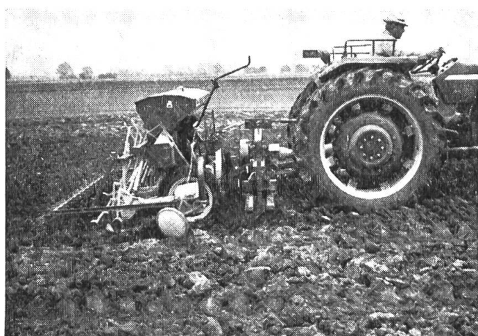
Abb. 2: Bestellsaat nach einer Pflugfurche. Die Gerätekombination besteht aus einer Rüttelege und einer Drillmaschine. Nach einem Arbeitsgang ist das Feld bestellt!
