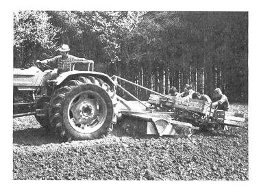
Abb. 9: Kombination Saatbettbereitung (Fräse) und Pflanzen (Kartoffelsetzgerät) in einem Arbeitsgang.
