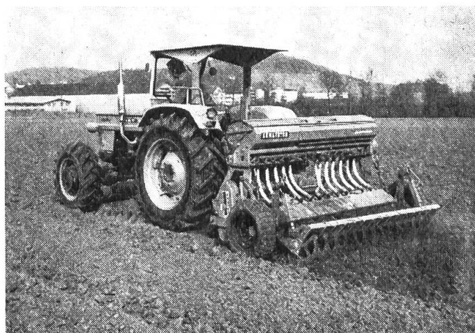
Abb. 7: Das Frässaatverfahren, d. h. die Kombination von Fräse und Aufbausämaschine, ist heute als das vielseitigste Verfahren anzusehen, da auf gepflügtem oder auch auf unbearbeitetem Boden eine Drill-, Band- oder Breitsaat angelegt werden kann.
