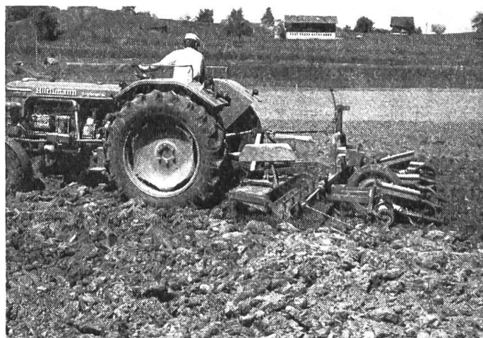
Abb. 4: Gerätekombination mit Kreiselegge und Einzelkornsägerät für die Maissaat.
