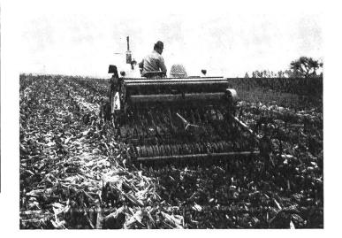
Abb. 8: Frässaat mit Saatgutablage nach der Fräswelle auf abgeerntetem Körnermaisfeld. Für 2,5 m Arbeitsbreite sind bis zu 100 PS erforderlich.
