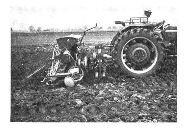
Abb. 2: Bestellsaat nach einer Pflugfurche. Die Gerätekombination besteht aus einer Rüttelegge und einer Drillmaschine. Nach einem Arbeitsgang ist das Feld bestellt!
