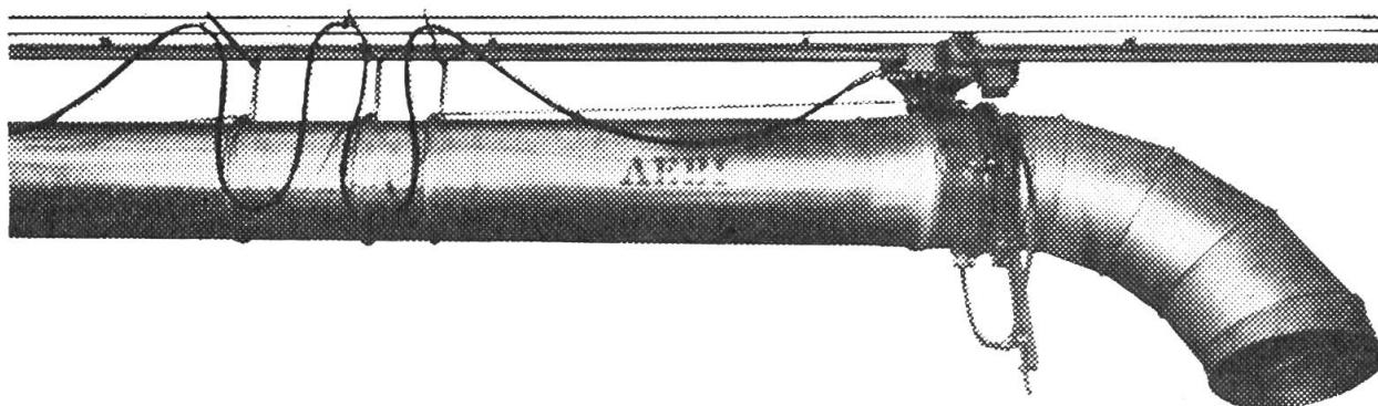
Den vollautomatischen Flächenverteil Fe-Gu mit Elektro-Antrieb, passend zu Rohr Ø 400 und 500 mm, für Stockflächen bis 7 m Länge und 12 m Breite.
