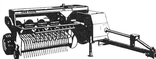
Die neue Hochdruckballenpresse mit einer Leistung bis 20 t/h. Die 1,80-m-Pick-up ist die breiteste Pick-up, die auf dem Markt angeboten wird. Durch den extra langen Presskanal in Verbindung mit der hydraulischen Einstellung der Pressdichte werden auch unter schwierigsten Erntebedingungen einwandfreie Ballen geliefert. Die Zentralschmierung gewährleistet einwandfreie und schnelle Schmierung der Nadeln und des Knüpfapparates.
