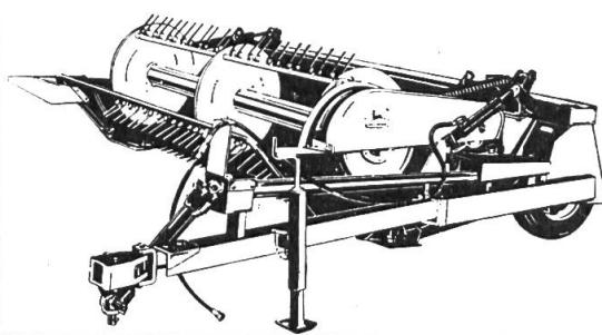
Spart Zeit, Geld und vermeidet Nährstoffverluste. Schneiden, Quetschen und Zetten in einem Arbeitsgang. Schwaden oder Breitstreuen durch einfaches Verstellen der Schwadbleche. Futter mit wesentlich höherem Nährwert, da viele Blatteile und kleine Stengel, im Gegensatz zu herkömmlichen Methoden, erhalten bleiben.
