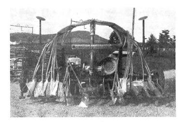
Abb. 3: Prüfung der Sägenauigkeit der einzelnen Reihen (Absackmethode).
