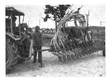
Abb. 2: Sämaschine in Transportstellung (Längsfahrvorrichtung mit Accord-Schnellkupplung).
