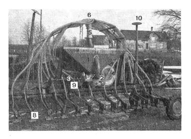
Abb. 1: Bauart der pneumatischen Sämaschine «Accord» (4m).
