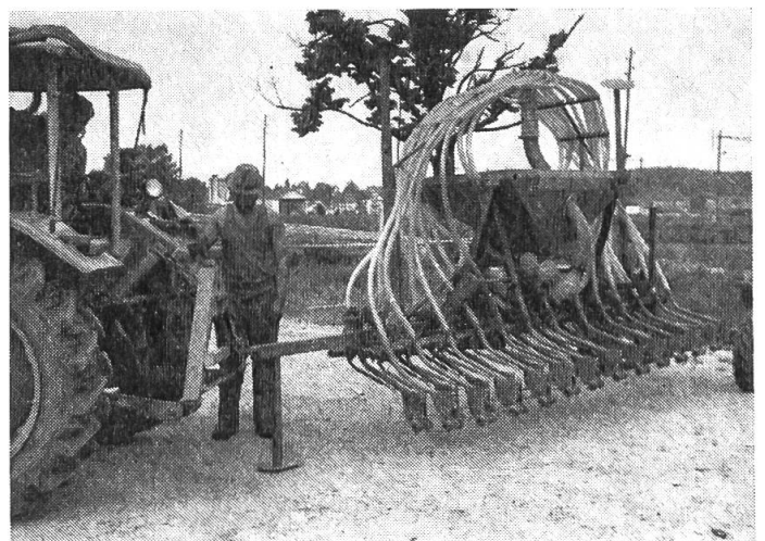
Abb. 2: Sämaschine in Transportstellung (Längsfahr-vorrichtung mit Accord-Schnellkupplung).
