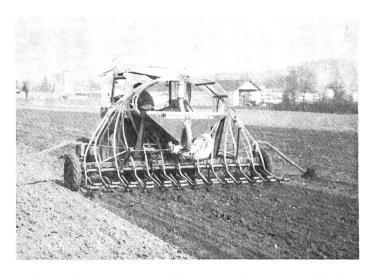
Abb. 6: Sommerweizen-Saat mit der pneumatischen Sämaschine.
