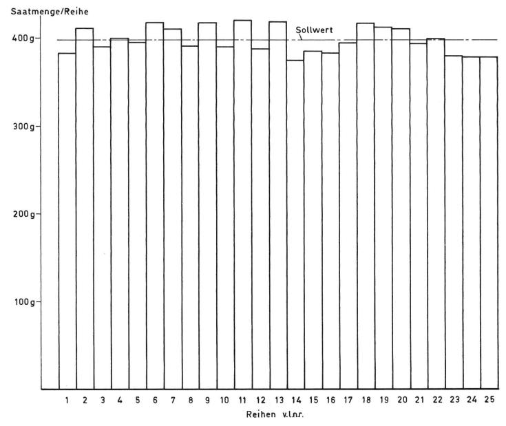
Abb. 4: Samenverteilung auf die Reihen (abgedreht auf 10 a). Mischung von Weizen und Kleegras, Saatmenge 100 kg/ha.
