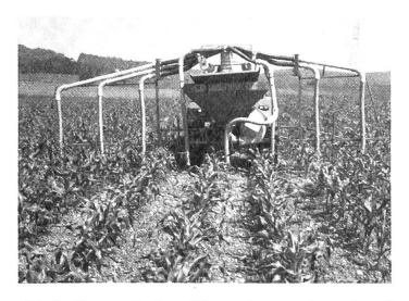
Abb. 8: Pneumatischer Düngerstreuer «Accord» mit einer Vorrichtung für die Reihendüngung (Maisfeld)
