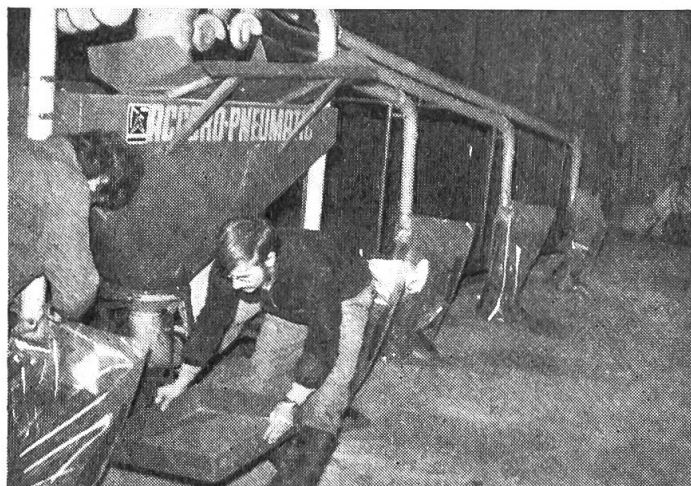
Abb. 3: Prüfung der Düngerverteilung auf die Streudüsen
