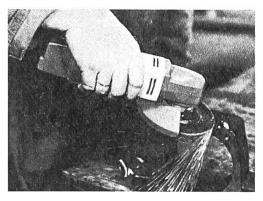
Der Einhandwinkelschleifer soll nur als Zweitmaschine in Betracht gezogen werden, weil er als Einzelmaschine dauernd überfordert würde.
