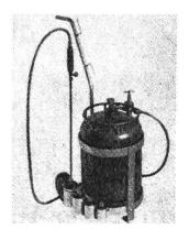
Propangasanlagen mit Injektorbrenner können Anforderungen welche bei der Metallbearbeitung an sie gestellt werden, selten erfüllen.
