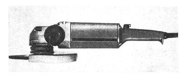
Der Winkelschleifer muss Trennscheiben mit einem Durchmesser von 230 mm aufnehmen, damit eine genügende Trenntiefe erreicht wird.
