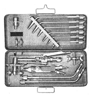
Auch wenn die Autogenanlage nicht allzu oft gebraucht wird, müssen Armaturen, Brenner und Zubehör präzis und solid gebaut sein und eine einwandfreie Funktion gewährleisten. Die Flaschen müssen ausserdem gegen Umfallen gesichert sein.
