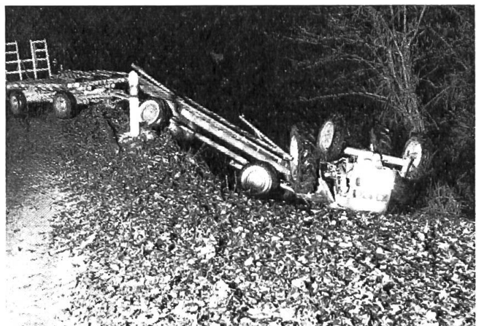
Abb. 1: Leere Anhänger haben das Zugfahrzeug über den Strassenrand (Kurve) hinausgestossen.
