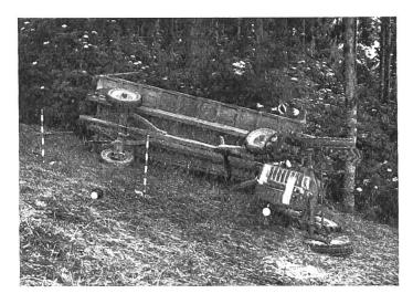
Abb. 3: Auch dieser mit Heinzen leicht beladene Anhänger brachte den Traktor zum Gleiten und zum Sturz.
