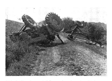
Abb. 2: Der leere Anhänger brachte den Traktor – sogar den allradgetriebenen – auf einer Bodenwelle ins Gleiten.
