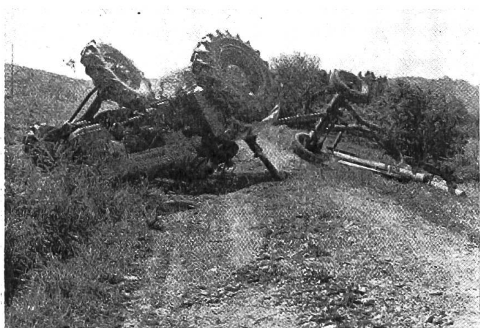
Abb. 2: Der leere Anhänger brachte den Traktor – sogar den allradgetriebenen – auf einer Bodenwelle ins Gleiten.
