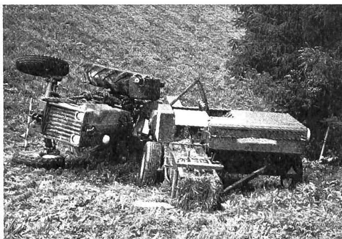
Abb. 4: Nicht nur schwere Pressen (Bild), sondern auch leichte Pressen können die Zugmaschine im Hanggelände zum Gleiten und zum Sturz bringen.
