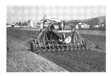
Einzelkornsägerät mit Schöpfbechersystem. Auswechselbare, der Korngrösse entsprechende, Becher bringen den Samen mechanisch gesteuert in die Furche.
