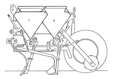
Eine Maschine zur Düngung, Saatbettzubereitung und Saat in einem Arbeitsgang.
