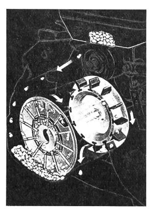
Einzelkornsägerät mit Klemmfingersystem. Die 12 Klemmfinger nehmen die Körner auf, passieren eine Holperstrecke zur Vermeidung von Doppelbelegungen und übergeben die einzelnen Körner einem synchron-laufenden Kammerrad, welches den Transport des Samens zur Furche übernimmt.
