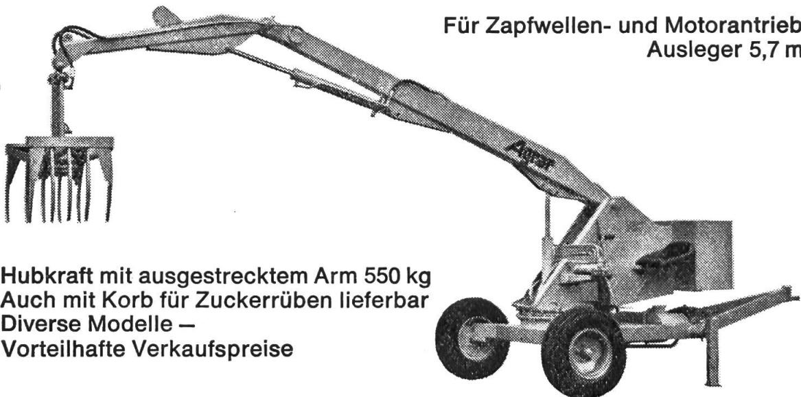
Für Zapfwellen- und Motorantrieb
