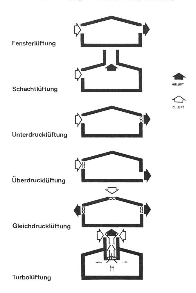
gasen). Das Turbo-Lüftungssystem benötigt keine Kanäle. Der Spezial-Ventilator fördert einerseits die Frischluft mit verhältnismässig hoher Geschwindigkeit (4–5 m/s) in den Stallraum und saugt anderseits gleichzeitig die verbrauchte Luft ab. Der Frischluftstrom ist gut steuerbar. Ein Thermostat regelt die Umluftsteuerung und die Heizung. In Abb. 2 werden die Möglichkeiten einer symmetrischen Lüftungsöffnungsanordnung für einen Stall mit Satteldach dargestellt.
