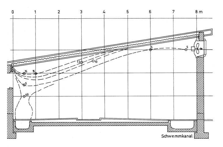
Entfernung dieser Gase nicht dem Lüftungssystem zu übertragen. Nach Abb. 9 setzt sich Ammoniak an der Decke ab; er ist spezifisch sehr leicht.
