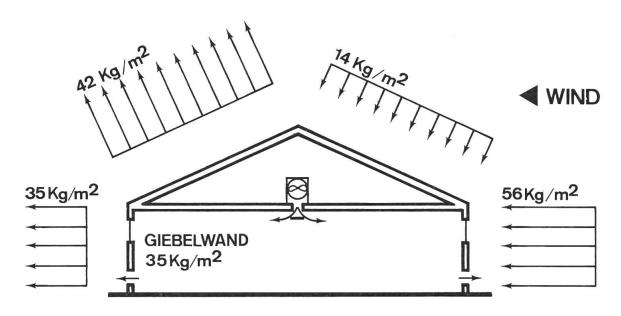
Abb.3b: BELASTUNGSANNAHME NACH DIN 1055.4
