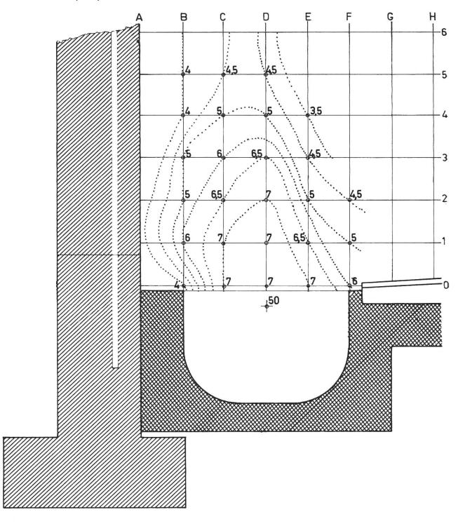
Oeffnung darf nicht windexponiert sein. Unterdrucklüftungen, die irgendwo über dem Rost die Stalluft ansaugen, können Vergiftungen verursachen. Abb. 8 weist deutlich die grösste Ammoniakkonzentration
