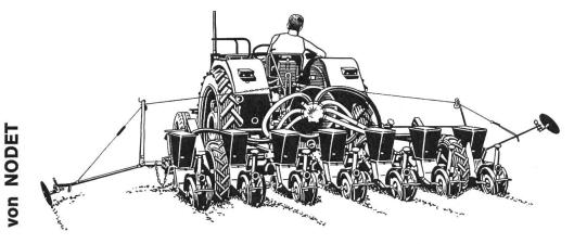
die pneumatische Einzelkornsämaschine für Mais, Bohnen usw. sowie für Zuckerrüben (pilliert und unpilliert). Feinsämereien ab 0.8 mm Ø.
