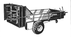
Tiefgangstreuer mit Streubreite bis 4,5 m. Er ist etwa so konstruiert wie die grossen Modelle und hat eine Brückengrösse von 125 x 300 cm und ein Gewicht von ca. 680 kg. Streuwerk mit 2 stehenden Walzen (auf Wunsch und gegen Mehrpreis Feinstreuwerk, ebenfalls mit 2 stehenden Walzen). Der STEINBOCK kann ebenso gut auch durch Flachlandbetriebe verwendet werden. Auskünfte und Unterlagen durch die Generalvertretung:
