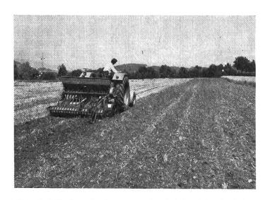
Abb. 9: Mit dem Aufkommen der Minimal-Bodenbearbeitung gewinnen die Bodenfräsen wieder an Bedeutung.
