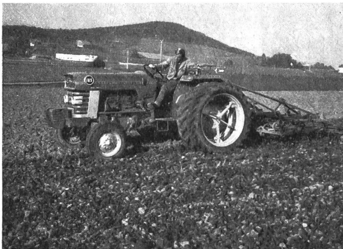
Abb. 7: Eine Kulturegge mit Krümmler gehört heute zu den meist verwendeten Saatbettvorbereitungsgeräten.
