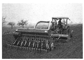
Abb. 12: Die Gerätekombinationen beanspruchen infolge ihres hohen Gewichtes die Traktorhydraulik übermässig stark. Eine Lösung bietet hier ein eigens hiefür gebauter Geräteträger.
