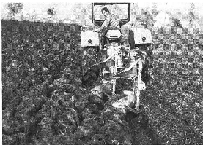
Abb. 2: Die Flächenleistung steigt nicht proportional mit dem Motorleistungsbedarf. Es ist deshalb besser zum Beispiel einen Zweischarpflug einzusetzen als mit einem Einscharpflug rascher zu fahren.
