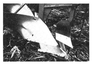
Abb. 3: Zum Maisstrohunterpflügen eignen sich Pflüge mit speziell geformten Vorschälern und Sechen.
