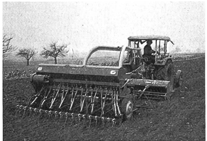
Abb. 12: Die Gerätekombinationen beanspruchen infolge ihres hohen Gewichtes die Traktorhydraulik übermässig stark. Eine Lösung bietet hier ein eigens hierfür gebauter Geräteträger.
