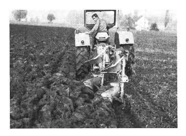
Abb. 2: Die Flächenleistung steigt nicht proportional mit dem Motorleistungsbedarf. Es ist deshalb besser zum Beispiel einen Zweischarpflug einzusetzen als mit einem Einscharpflug rascher zu fahren.
