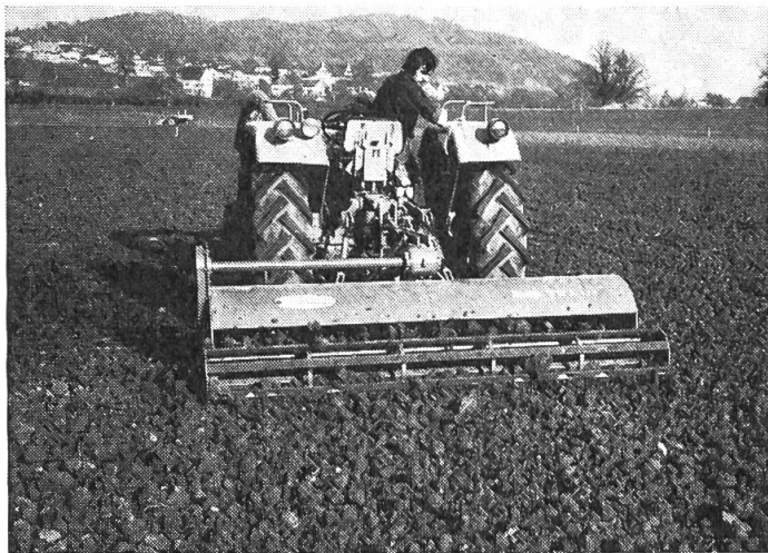
Abb. 11: Das Arbeitsorgan einer Taumelwälz egge besteht aus hin und her schwenkenden Zinkensternen. Mit der Egge wird das Absetzen des frischgepflügten Bodens beschleunigt.
