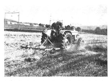
Abb. 5: Ein Tiefgrubber eignet sich gut für die Lockerung von mechanischen Verdichtungen.
