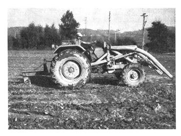
Abb. 6: Für tiefverdichtete, nasse Böden verwendet man am besten einen Maulwurfdränagepflug.
