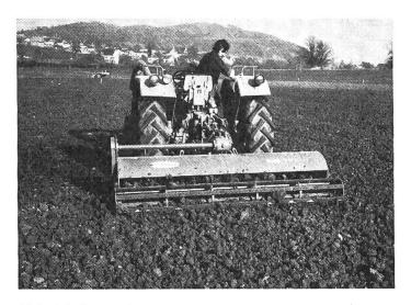
Abb. 11: Das Arbeitsorgan einer Taumelwälzegge besteht aus hin und her schwenkenden Zinkensternen. Mit der Egge wird das Absetzen des frischgepflügten Bodens beschleunigt.
