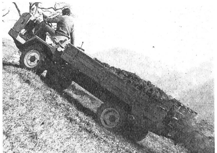
Der Reform Muli 45 im Einsatz als selbstfahrender Miststreuer.
