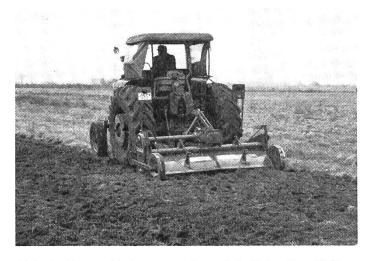
Abb. 1: Krone-Motoregge, 3 m Arbeitsbreite, Seitenantrieb.
