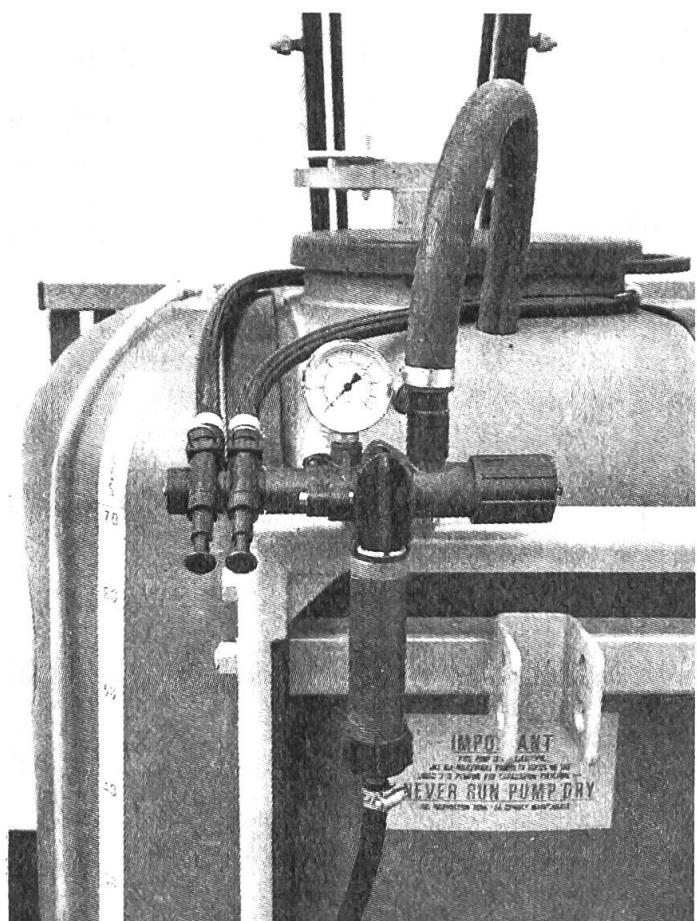
An der vergangenen Royal Smithfield Show (London 4.–8.12.1972) war ein neues Steuergerät für Traktoranbau-Spritzen zu sehen. Das Gerät kann an die Schädlingsbekämpfungsspritzen der unten genannten Firma angeschlossen werden. Dank einer Ansaugvorrichtung verhindert es das Ausfliessen von Spritzbrühe und somit die bekannten Verbrennungen an den Pflanzen.
