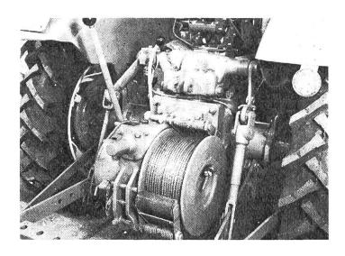
Das Schwenklager der Seilführung wie auch das Seilrollenlager sind starken Verschmutzungen ausgesetzt. Diese Teile müssen daher in kurzen Abständen gereinigt und sehr oft geschmiert werden. Bei automatischer Seilführung sind ebenfalls die Gleitbahnen der Verschmutzung sehr stark ausgesetzt und müssen deshalb recht oft, mindestens täglich geschmiert werden. Abgenutzte Teile rechtzeitig erneuern.
