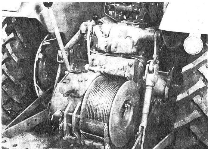
Das Schwenklager der Seilführung wie auch das Seilrollenlager sind starken Verschmutzungen ausgesetzt. Diese Teile müssen daher in kurzen Abständen gereinigt und sehr oft geschmiert werden. Bei automatischer Seilführung sind ebenfalls die Gleitbahnen der Verschmutzung sehr stark ausgesetzt und müssen deshalb recht oft, mindestens täglich geschmiert werden. Abgenutzte Teile rechtzeitig erneuern.
