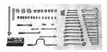
Der Grundstock des Werkzeuges: Gabel-, Ring- und Steckschlüssel . . .
