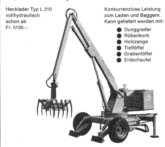
**Krüger** seit mehr als 10 Jahren spezialisiert auf Hydrauliklader. **Krüger** seit 10 Jahren der meistgekaufte Hydrauliklader **in der Schweiz**. Führend in Leistung und Qualität — **z. B. Typ L 230** hebt 1000 kg am gestreckten Arm, ca. 2500 kg am halben Arm, greift 5,5 m weit und steht beim Laden «bockstill». — Grosse Kraftreserve und deshalb längere Lebensdauer.
