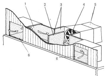
Abb. 3: Beispiel für eine Gebläse-Schallabschirmung nach beiden Seiten.
