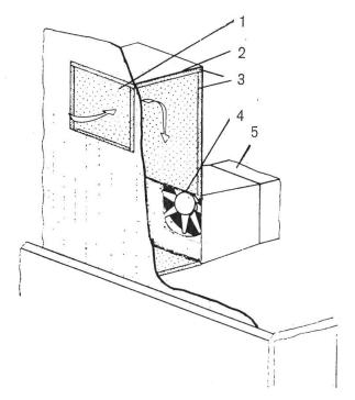
Abb. 2: Beispiel für eine Gebläse-Schallabschirmung nach oben.
