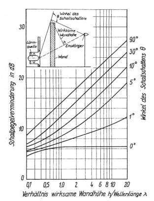
Abb. 1: Schallschutz durch vorgesetzte Wand.
