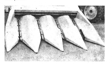
Abb. 9a: Vierreihiger Pflückvorsatz. Die Maisstengel werden von den Ketten nach hinten gefördert...
