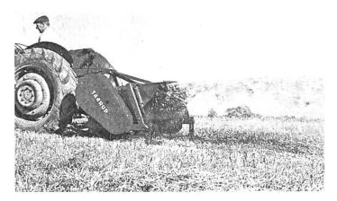
Abb. 12: Dreipunkt-Strohfräse mit verstellbaren Verteilerblechen. Das Arbeitsprinzip ist ähnlich wie beim Schlegelhäcksler.
