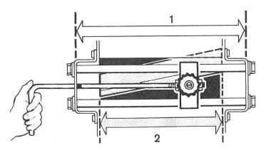
Abb. 5b: Prinzipskizze einer Schleifvorrichtung. 1 = Schleifweg 2 = Messerbreite
