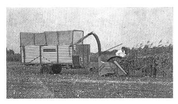
Abb. 1a: Geschlossene Arbeitsketten sind anzustreben, wie hier vom Anbauhäcksler über den Automatikwagen...
