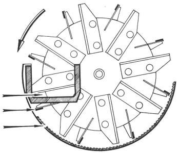
Abb. 8: Trommelgehäuse eines Pflückschroters mit Riffelplatte.
