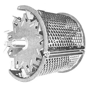
Abb. 14: Detailaufnahme: Trommel mit 9 Messern und Siebmantel.
