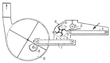
Abb. 13: Prinzipskizze Recutter-Gebläse-Kombination zur Zerkleinerung von Maiskolben oder Maiskörnern.
