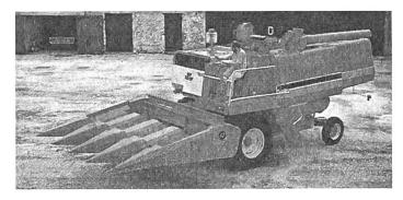
Abb. 10: Bei 4-reihiger Saat hilft der 4-reihige Pflückdrescher Schwierigkeiten mit den Anschlusspuren umgehen.
