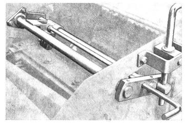
Abb. 5a: Kurzhäcksel setzt einen tadellosen Zustand der Arbeitswerkzeuge voraus. Ohne Schleifvorrichtung wird der beste Häcksler zur Illusion.
