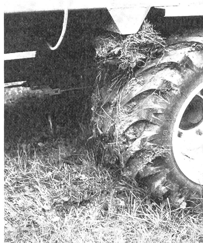
Abb. 1: Ein kleines Detail, der Kotabstreifer. Er hebt den Schmutz bei den Doppelrädern weg. Wenn der Kotabstreifer wie hier vor den Rädern montiert ist, wird der wegfallende Schmutz wieder vom Rad aufgewickelt.
