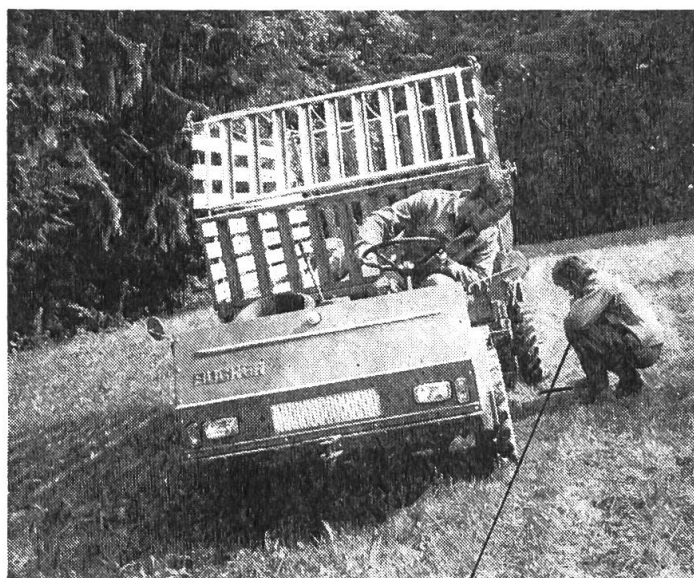
Abb. 2: Messung der Abtrift auf nassem Boden bei 30% Neigung.
