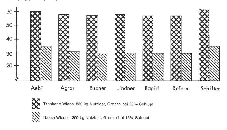
Darstellung 3: Ergebnisse der Abtriftmessung rAbtriftwinkel in Grad
