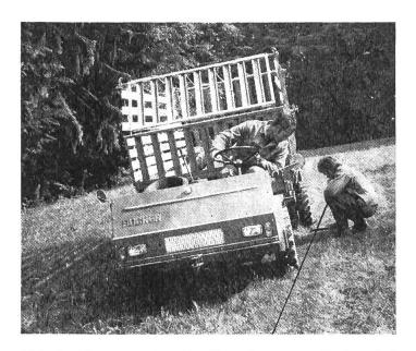
Abb. 2: Messung der Abtrift auf nassem Boden bei 30% Neigung.
