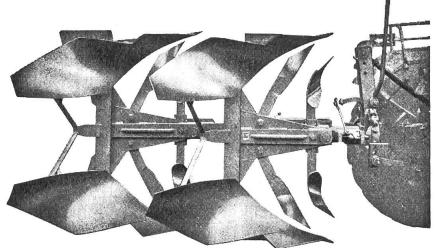
sind leichtzügiger und arbeiten besser Tausendfachbewährte, unübertroffene halbautomatische Wendevorrichtung. Grosser Durchlass zwischen den Pflugkörpern. Beide Furchen in der Breite genau einstellbar. Riestern aus chromlegiertem Panzerstahl, gegen Abnützung besonders widerstandsfähig. Zuverlässige Bruchsicherungen.
