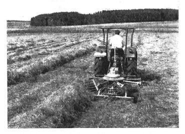
Spezial-Schwadgerät für Anhängung und Anbau.
