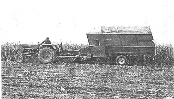
Abb. 2: Beim Häcksler-Ladewagen Landsberg werden die Arbeitsgänge Häckseln, Transportieren und Ab- laden von einer einzigen Maschine besorgt. Der Häcksler übernimmt beim Abladen die Funktion eines Gebläses. — Für eine regelmässige Beschickung sor- gen zwei Dosierwalzen. Da die Maschine jedoch ein grosses Leergewicht und eine relativ geringe Nutz- last hat, kann sie nur auf ebenen und arrondierten Betrieben wirtschaftlich eingesetzt werden.
