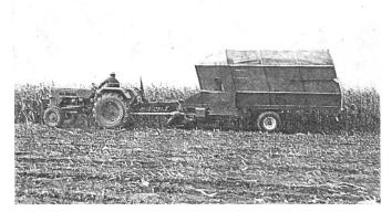
Abb. 2: Beim Häcksler-Ladewagen Landsberg werden die Arbeitsgänge Häckseln, Transportieren und Abladen von einer einzigen Maschine besorgt. Der Häcksler übernimmt beim Abladen die Funktion eines Gebläses. — Für eine regelmässige Beschickung sorgen zwei Dosierwalzen. Da die Maschine jedoch ein grosses Leergewicht und eine relativ geringe Nutzlast hat, kann sie nur auf ebenen und arrondierten Betrieben wirtschaftlich eingesetzt werden.
