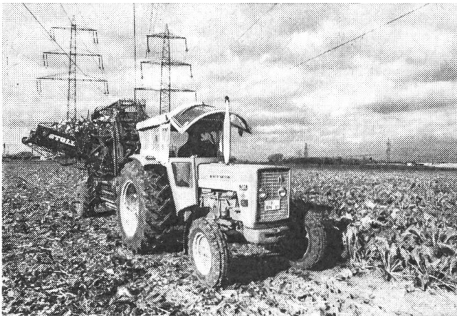
Abb. 1: Der einreihige Bunkerköpfroder, in Einmannarbeit dank hydraulischer Bedienung einzusetzen, beherrscht nach wie vor die Zuckerrüben-ernte. Erst vereinzelt arbeiten mehrreihige Rübenroder entweder als gezogene Geräte oder als Selbstfahrer. Auch das sechsreihige französische Ernteverfahren mit 3 einzeln eingesetzten Geräten (Köpfen - Roden - Aufladen) hat Anhänger gefunden. Foto: W. Schiffer
