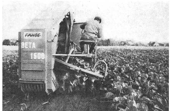
Abb. 2: Auch die Ernte der Futterrüben ist heute mit einreihigen Rodegeräten möglich, die die Rüben aus dem Boden ziehen, den Blattschopf abschneiden und die Rüben im Bunker sammeln. Voraussetzung sind blattrreiche, hoch genug aus dem Boden wachsende Futterrüben. Foto: W. Schiffer
