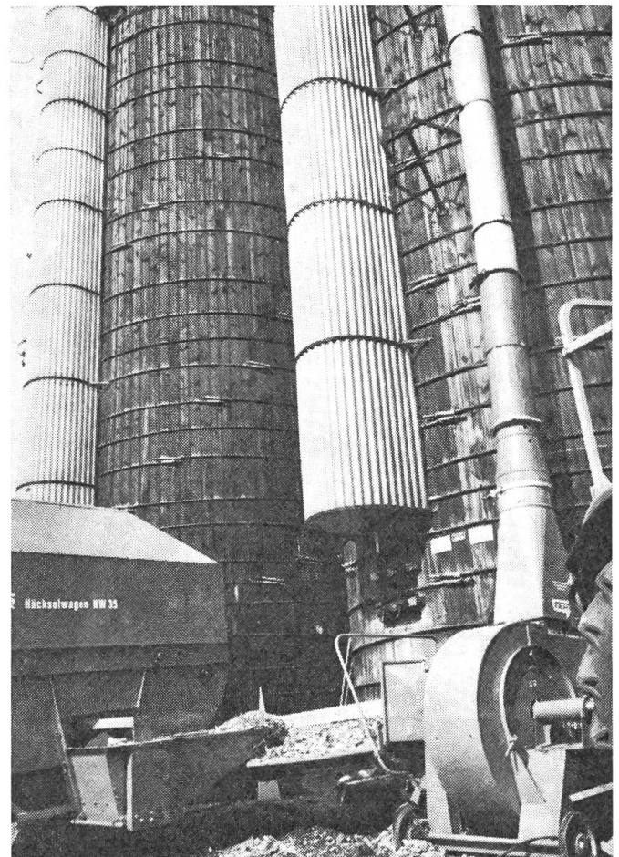
Abb. 3: Hinten am Häckselwagen ist ein Querförderer zum Beschicken von stationären Gebläsen angebaut. Ein Gebläse zum Beschicken des Hochsilos kann auch direkt montiert werden, mit dem Vorteil, dass das Siliergut unter Ausnützung der vorhandenen Traktor-PS weitergefördert werden kann. (Photo V. Monhart)
