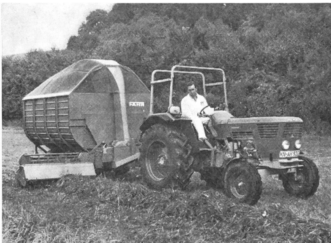
Abb. 1: Dem Häckselwagen MH 35 stehen als Vorsatzgeräte wahlweise das Pic-up, die Maismähvorrichtung, der Kolbenpflückschroter oder der Rübenköpfschlitten zur Verfügung. (Werkphoto)
