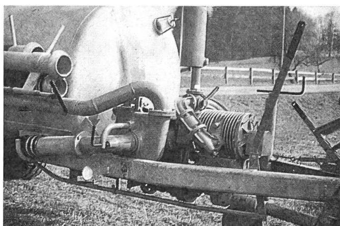
Die Technik findet immer wieder neue Lösungen und Kombinationen. Wenn der Kompressor zu wenig Druckgefälle zum Gülle-Ausbringen im Hanggelände aufbringt, schafft eine aufgebaute Zentrifugalpumpe eine Höhendifferenz von 30–50 m. Bezuglich Verstopfung durch Stroh usw. ist diese Pumpe anfälliger als die Vakuumpumpe, die mit der Gülle nicht direkt in Berührung kommt.
