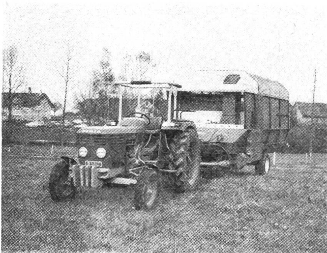
Abb. 1: Häckslerladewagen mit Pick-up. Oben ist der Rohranschluss für die Steigleitung ersichtlich (System Landsberg).
