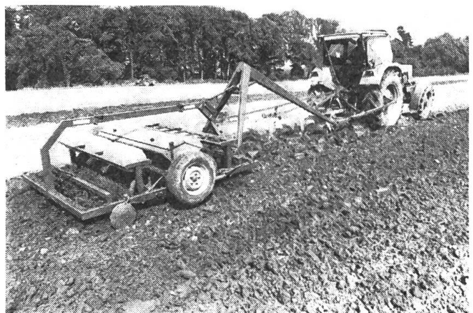
In einer Pflug-Sä-Kombination kann der Bestell-Minimat zur arbeitssparenden Einsaat von Zwischen- und Hauptfrüchten eingesetzt werden. Foto: W. Schiffer
