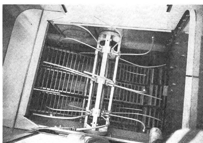
Die neuen John-Deere-Mähdrescher sind mit einem Quer-Schüttlersystem ausgerüstet, das über den Hordenschüttlern liegt und das durchlaufende Stroh nochmals querschüttelt. Die hiermit erzielte Mehrleistung soll einer um 25 % vergrösserten Schüttlerfläche entsprechen.
