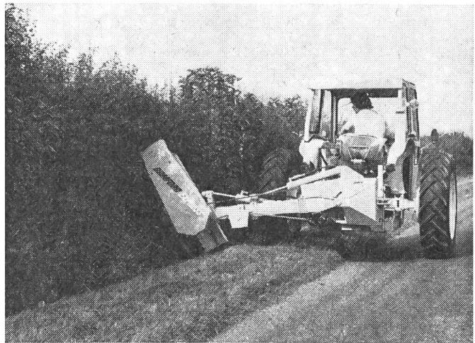
Eine Hecke – sie kann einem Wegrand oder einer Gutsgrenze entlang führen – kann nunmehr mit einem mittels Verlängerungsarm am Traktorheck angebauten Schlegelmäher (Roadside) zurückgeschnitten werden. Die Reichweite der äussersten seitlich schräggestellten Schnittfläche beträgt lediglich 2,9 m. Das erleichtert das Arbeiten in engen Verhältnissen. Die eigentliche Schnittbreite beträgt 1,15 m. Mit diesem Anbau-Schlegelmäher können angeblich 9800 m<sup>2</sup> je Stunde geschnitten werden.
